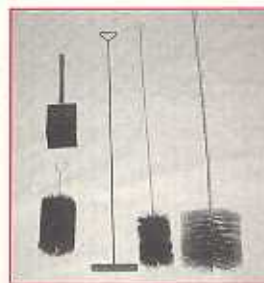
Werkzeuge zur Reinigung von Feuerstätte und Rauchrohr
